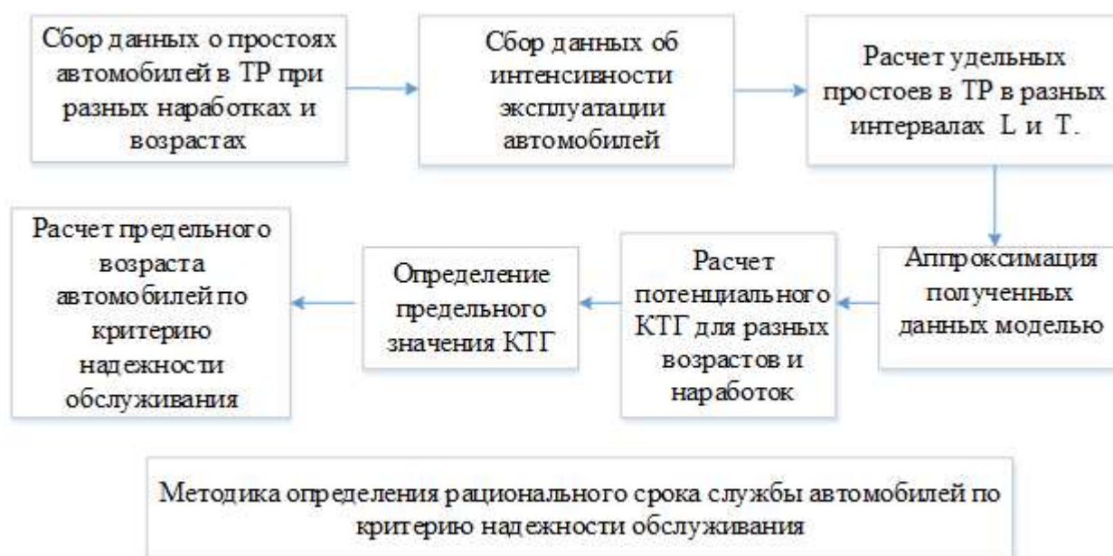
Рисунок 4.1 -Методика расчета рационального срока службы автомобилей по критерию надежности обслуживания
