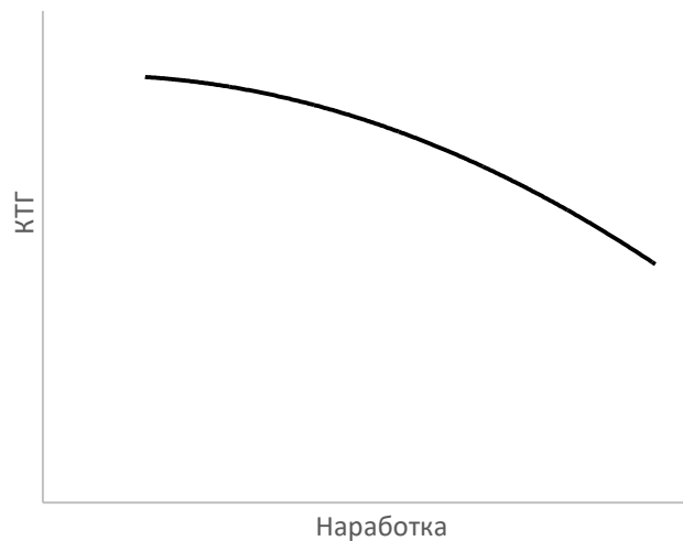
Рисунок 2.10 - Гипотеза о виде математической модели влияния наработки автомобиля на КТГ при средней наработке
