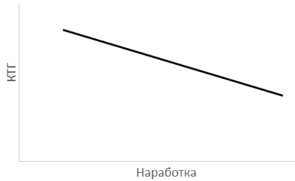
Рисунок 2.9 – Гипотеза о виде математической модели влияния наработки автомобиля на КТГ при малой наработке
